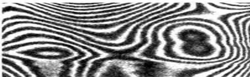
*Объяснение:* Поверхности пластинок не могут быть совершенно ровными, поэтому соприкасаются они только в нескольких местах. Вокруг этих мест образуются тончайшие воздушные клинья различной формы, дающие картину интерференции. В проходящем свете условие максимума  $2h=kl$
