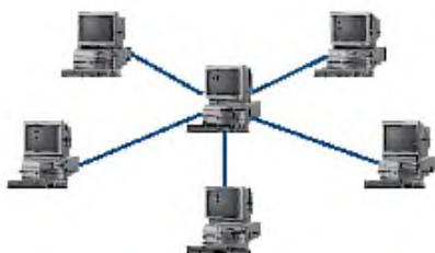
каждый из них использует свою отдельную линию связи. Весь обмен информацией идет исключительно через центральный компьютер, на который ложится очень большая нагрузка, поэтому он предназначен только для обслуживания сети.
