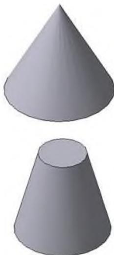
Рис. 70 Твердотельные модели конусов
