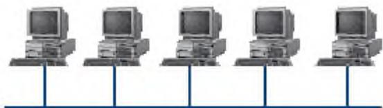
одной линии связи, и информация от каждого компьютера одновременно передается ко всем остальным компьютерам.
