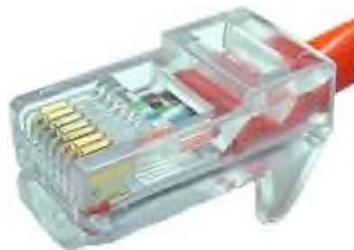
Рисунок 5 Правильно оконцованный кабель типа UTP
