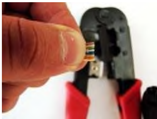
Рисунок 4. Используем резак на кримпере
