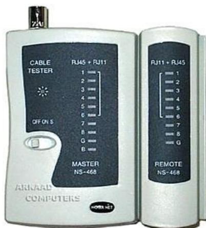
Рисунок 3.21 Сетевой тестер
