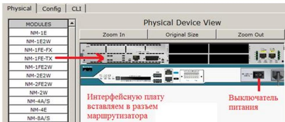
**Рис. 31.** Вставляем интерфейсную плату в маршрутизатор
