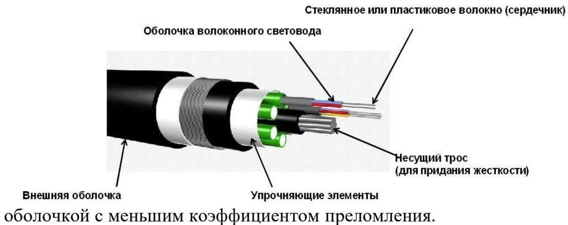
Рисунок 3.6 Волоконно-оптический кабель
