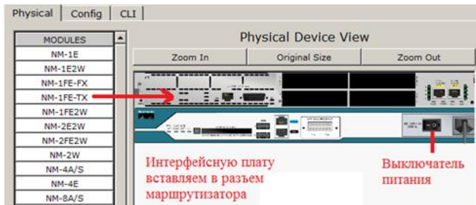
Рис. 31. Вставляем интерфейсную плату в маршрутизатор
