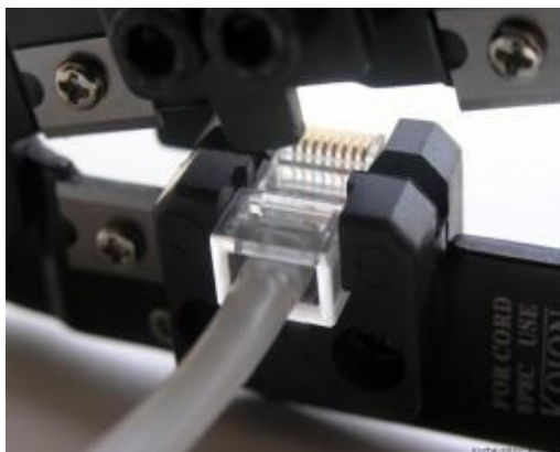
Рисунок 3.18 Обжим разъема RJ-45 кримпером
